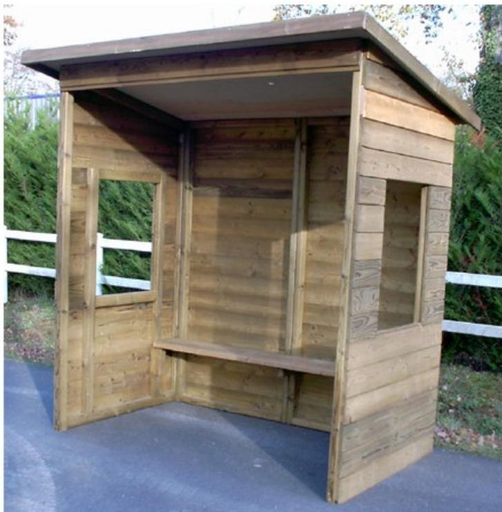
Structure bois avec fenêtres, essence pin nord rouge Finlande, catégorie 5, gage de stabilité et de haute résistance. Traitement autoclave classe III, sans chrome ni arsenic. Bardage en clin plat ép. 21 mm sur cadre. Toit en tôle acier laqué. Banc sur toute la longueur.
