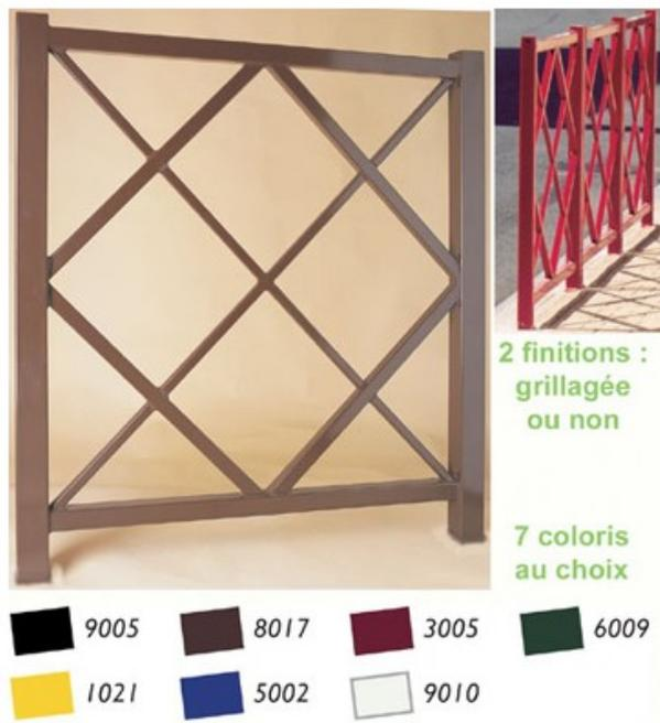
En acier galvanisé à chaud (+,- 80 microns), lui apportant une protection remarquable. Coloration obtenue par thermolaquage (poudre polyester cuite au four), isolant et décoratif. Barrière fixe à sceller. Hauteur hors sol : 1,06 m. Hauteur totale : 1,28 m. Montants latéraux : tube carré de 60 X 60 X 3 mm. Lisses : tube carré de 40 X 40 X 2 mm. Croix : tube carré de 20 X 20 X 2 mm. Renfort : tube rectangle de 60 X 30 X 2 mm.
