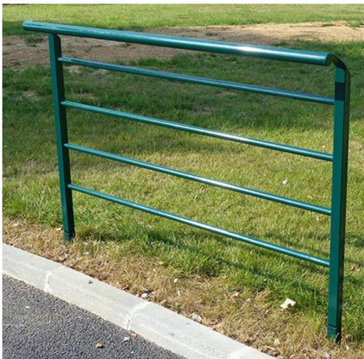
Main courante en tube de Ø42. Montants en tube de 40x40. Tube intermédiaire de Ø26.9. Finition coloris gris anthracite ral 7016. Dim (cm) : L 150.4 x P 16.9 x H 123. Hors sol 100 cm, scellement 23 cm. Poids 17 kg. Option : kit d'amovibilité.
