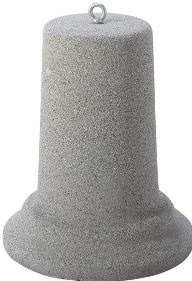
Fabriquée en béton de haute qualité : résistance au gel : 25 cycles de gel (-25degrés C) avec dégel (+15degrés C), sans observer de fissures, de laminations, ou d'exfoliations. Coloris : gris. Autres coloris, nous consulter. Possibilité de traitement anti-graffitis par film protecteur : plus-value de 10.
