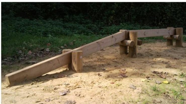
Bois pin du nord Rouge Finlande, catégorie 5, gage de stabilité et de haute résistance. Traitement autoclave classe IV, sans chrome ni arsenic. Principe de l'atelier : traverser la poutre en marchant. Zone d'implantation : 6 X 3,4 m. Ensemble composé d'une poutre oblique à 6 degrés et d'une droite de longueur 200 cm, fabriquées en rondins de diamètre 10 et 14 cm. H hors sol 50 cm. A sceller. Livré avec panneau de consignes.
