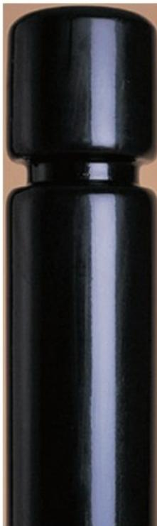
Robustes, esthétiques et fonctionnels, ces potelets sont traités anti-corrosion, en acier galvanisé à chaud (+,- 80 microns). La coloration est obtenue par thermolaquage (poudre polyester cuite au four), isolant et décoratif. A sceller. Version amovible, sur platine de fixation, nous consulter. Dims : diamètre 101,6 mm X hauteur hors sol 120 cm.
