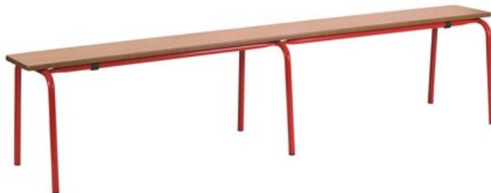
Structure monobloc. Piétement en tube acier diamètre 25 X ép. 1,5 mm. Renfort sous l'assise tube diamètre 25 X ép. 1.5 mm. Soudures avec apport de matière. Patin de protection de l'assise lors de l'empilage des bancs. Patins en ABS noir non tachant. Finition structure : Poudre époxy, plusieurs coloris au choix. Assise en panneau médium mélaminé ép. 19mm. Disponible en taille 4, 5, 6.
