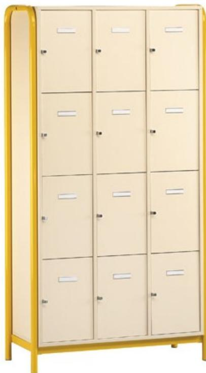
Structure en mélaminé ép. 19 mm. Chants ABS ép. 2 mm. Portes encastrées avec charnières invisibles à ouverture à 90 degrés et porte étiquette. Fermeture par morillon porte cadenas. Piètement acier. L X H X P hors tout 900 X 1830 X 450 mm. L X H X P d'une case utile : 272 X 395 X 410. Plusieurs coloris de panneaux et de piètement au choix, nous consulter.
