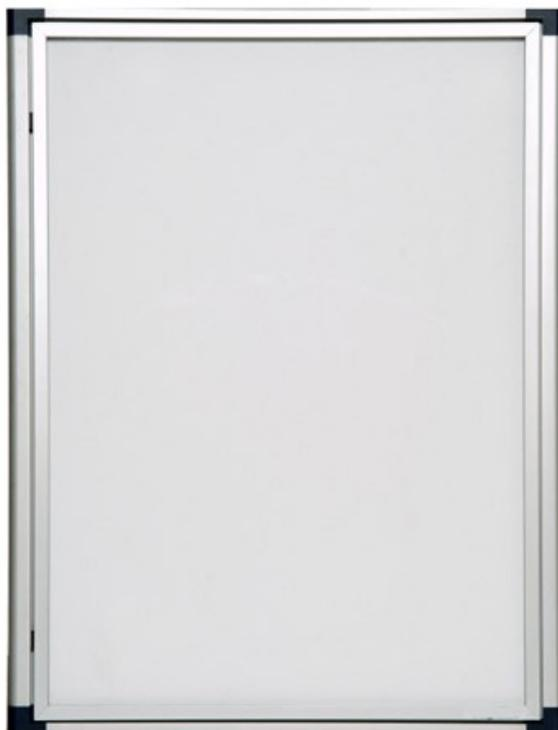
Utilisation en intérieur ou extérieur. Cadre en aluminium extrudé, finition anodisé naturel. Parement d'angles en plastique injecté bleu. Fixation par vis dissimulées dans les angles ou par adhésif double face. Fond en tôle laquée blanche pour affichage magnétique. Système de verrouillage dissimulé, ouverture par tige. Etanchéité assurée par des chicanes sur le pourtour. Vitre en altuglas ép. 3 mm. Dimensions H 94cm x L 49cm Epaisseur 15 mm.
