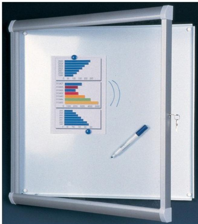
Encadrement aluminium anodisé naturel. Ouvrant (façade) verre sécurit. Ouverture droite ou gauche selon sens de la pose. Fermeture par serrure à clé. Fond tôle pré laquée blanche pour écriture feutre. Fixation murale inaccessible après verrouillage de l'ouvrant. Capacité 6 A4. Disposition (2 X 3). Dims (cm) hors tout H 70 X L 71.
