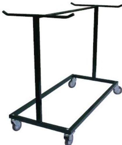
Super pratique pour faciliter la manutention de vos grilles d'exposition. Construction robuste en tubes d'acier. Structure en tubes carrés de 40X40mm. Bras de suspension en tube carré de 20x20mm. Dimensions (mm) : L1500 X H1190 X P720. Largeur des portants destinés aux grilles : 71 cm. Poids : 18kg. 4 roues pivotantes de diamètre 125 mm dont deux avec freins. Embouts antichute des grilles en polyamide noir. Finition peinture, cuite au four, RAL 6005.
