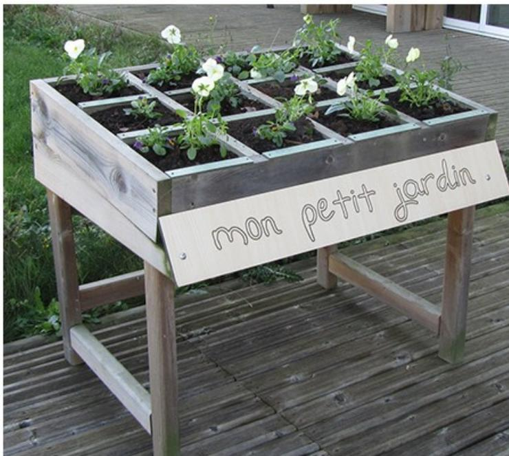
La structure idéale pour faire découvrir le jardinage aux plus jeunes ou offrir aux plus âgés un endroit pour retrouver des sensations. Structure en pin du nord Rouge Finlande, catégorie 5, gage de stabilité et de haute résistance. Traitement autoclave classe IV, sans chrome ni arsenic. Visserie inox A2. L'ensemble peut aussi être posé au sol. Bac composé de 12 compartiments de 20 X 20 X H 9 cm. Dims (cm) totale : H 76 X L 96 X P 73. Livré pré-monté, sans terre ni plantation.
