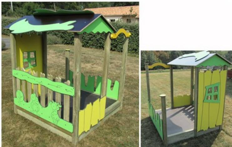
Cabane pour les 2 à 7 ans, avec hauteur de chute de 58 cm, surface amortissante 19 m<sup>2</sup>. Structure en pin rouge du nord, catégori 5, gage de stabilité et de haute résistance, traité autoclave, classe 4, sans chrome ni arsenic. Encombrement hors tout : 148 x 150 cm. Element décor compact imputrescible. Scellement : au nombre de 4, de diam 30 cm, P.50 cm, dosage béton 300kg/m<sup>3</sup>.
