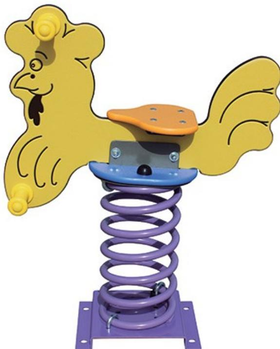
Jeux à ressort pour enfants de 1 à 12 ans, conforme à la norme EN 1176. Hauteur de chute 0,54 m. Espace d'implantation : 300 X 225 cm. Ressort en acier, finition peinture poudre polyester. Forme et assise en HPL, coloré et d'une grande stabilité. Boulonnerie en inox.
