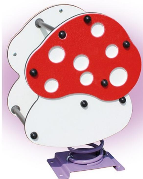
Jeux à ressort pour enfants de 1 à 12 ans, conforme à la norme EN 1176. Hauteur de chute 0,42 m. Espace d'implantation : 269 X 237 cm. Ressort en acier, finition peinture poudre polyester. Forme et assise en polyéthylène, coloré et d'une grande stabilité. Boulonnerie en inox.
