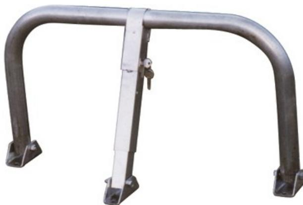
Ossature en tube d'acier zingué de diamètre 50 mm. Verrouillage automatique avec relevage de l'arceau. Livrée avec tiges de fixation. Dims (cm) : H 45 x L 85. Poids 10 kg.
