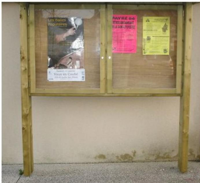
Version avec vitrine et sans toit. Structure bois essence pin nord rouge Finlande, catégorie 5, gage de stabilité et de haute résistance. Traitement autoclave classe IV, sans chrome ni arsenic. Visserie inox A2. Panneau en compact ép. 10 mm ou PVC komacel ép. 10 mm. Livré pré monté, à sceller. Option toit : clin plat à 2 pentes. Option vitrine : plexiglass 6 m, verrou avec serrure. Hauteur 220 cm.
