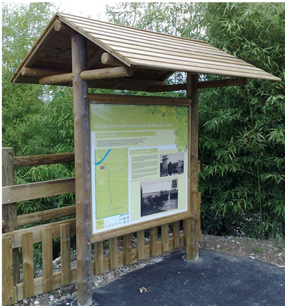
Structure fabriquée en pin traité classe IV. Panneau monté sur ossature en bois rond Ø 14 cm. Poteaux des traverses Ø 8 cm. Panneau d'affichage en CTBX ép. 15 mm. Toiture en bois, surface couverte 5 m<sup>2</sup>. Surface d'affichage 124 X 139 cm. Largeur hors tout : 200 cm. Hauteur hors sol : 250 cm. Longueur hors tout : 200 cm. A sceller. Vitrine, non incluse.
