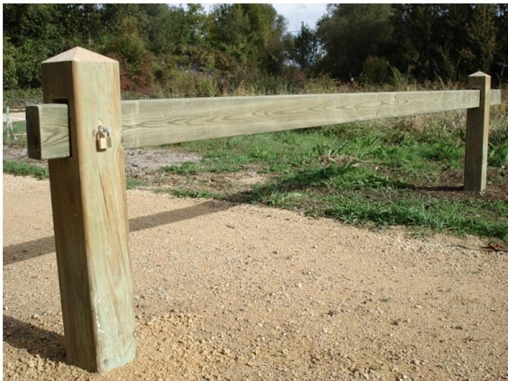
Idéal pour l'aménagement de vos sentiers de randonnées et de vos espaces publics. Des barrières coulissantes, pratiques et robustes. Fabriquées en pin traité autoclave classe IV garantie 10 ans. 2 poteaux de section 180 X 145 mm. 1 traverse de section 70 X 145 mm. Scellement à 40cm de profondeur. Fermeture par cadenas laiton. Hauteur hors sol 110 cm. Hauteur hors tout 150 cm. Fabrication française. Option : Cadenas pompier, clé 14 pompier et plaque signalétique.
