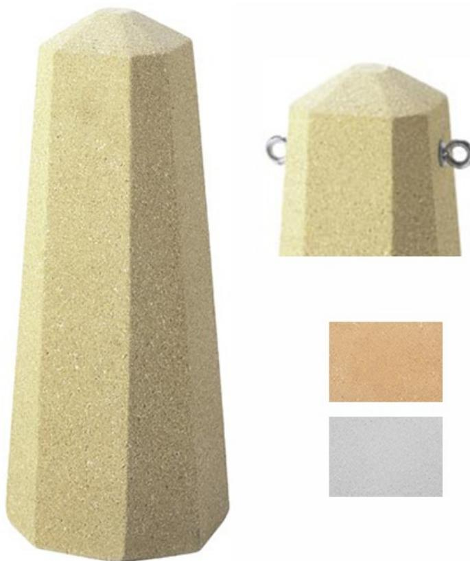
Bornes en béton de haute qualité : résistance au gel : 25 cycles de gel (-25 degrés C) avec dégel (+15 degrés C), sans observer de fissures, de laminations, ou d'exfoliations. Possibilité de traitement anti-graffitis par film protecteur : plus value de 10% . Coloris au choix : blanc ou ocre. Autres coloris, nous consulter.
