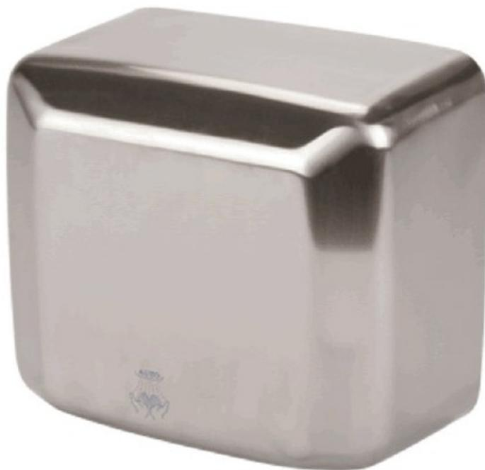
Sèche-main robuste particulièrement efficace et économique. Capot en inox, antivandalisme, épaisseur 2 mm. Déclenchement automatique par cellule. Arrêt automatique en cas de surtension. Temps de séchage 15 secondes. Puissance 2500 W. Niveau sonore : 70 dB. Livré avec son kit de fixation murale. Dims (cm) : L27 X P14,2 X H24. Poids : 5,40 kg. Garantie 3 ans.
