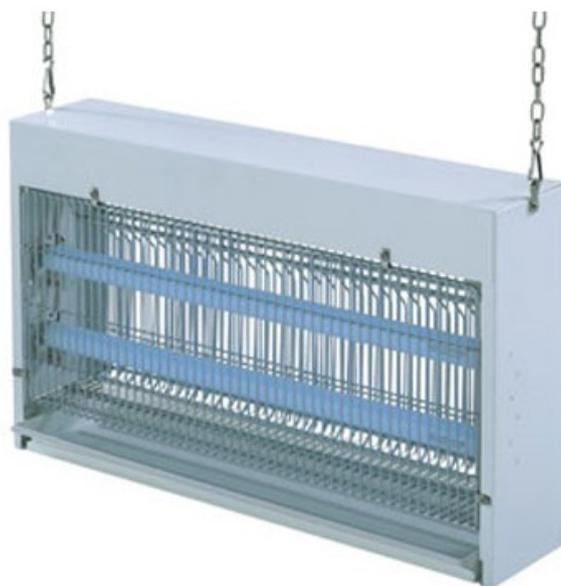
Modèles professionnels tout inox. Très grande surface de désinsectisation. Alimentation : 230 V, 50 Hz. Tension et intensité de la grille : 3 800 V, 10 mA. Interrupteur ON OFF. Cordon d'alimentation avec prise (95 cm). Isolation électrique classe I. IP20. Dims (cm) : 86 X 36,5 X 7. Poids : 5, 85 kg.
