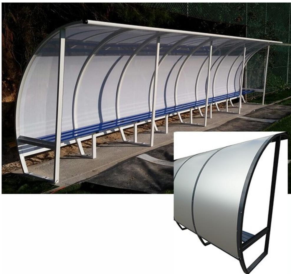
Abris de touche avec structure aluminium plastifié. Ossature principale en 60x30x2 mm. L'assise se compose de 3 lisses en tube d'aluminium section 20x80x2,5 mm. Profil arrondi en partie haute. Les cotés sont dotés de protections transparentes résistantes aux impacts de ballons en polycarbonate 2 mm. Protection arrière en aluminium composite 3 mm. Embouts de protection en PVC. A sceller. Dims (cm) : L350 x H160. Capacité : 7 joueurs.
