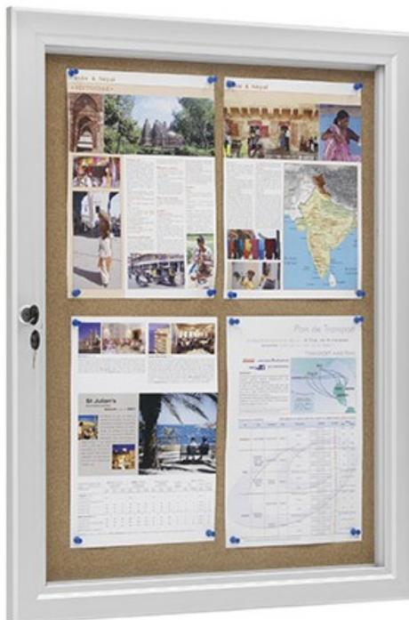
Pour un usage intérieur ou extérieur. Vitrage en polycarbonate incassable. Charnières de porte invisibles pour une grande sécurité. Extra-plates épaisseur totale 38 mm. Serrure 2 clés. Compas de sécurité pour maintien de la porte ouverte. Installation de l'ouvrant à droite ou à gauche ou bien à l'horizontale. Piètement et connecteurs uniquement compatibles avec cette gamme de vitrines. 2 serrures, Fond liège, qualité haute densité, livré avec 24 punaises. Capacité 6 feuilles A4. H 108 x L 59 cm
