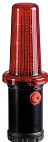
Feu clignotant pour panneau de signalisation conique. Se fixe sur le dessus du panneau. Imperméable pour une utilisation en extérieur. Muni d'un bouton d'allumage et d'extinction. Fonctionne avec 2 piles de 1.5 V. Autonomie environ 2 mois. Poids 90g
