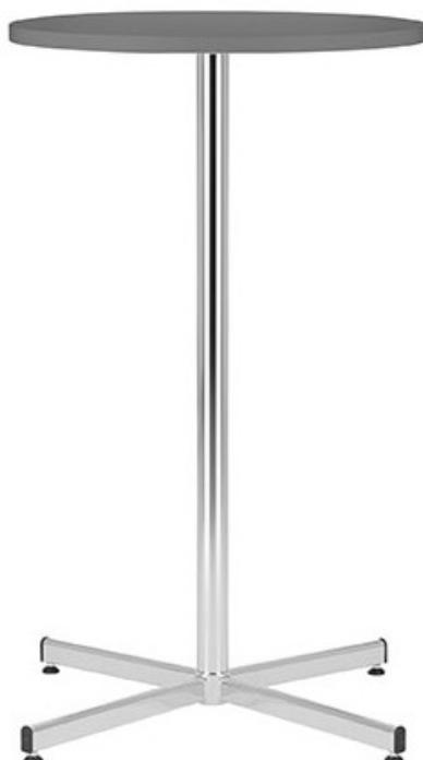
Mange debout moderne avec pied en croix. Structure en tube d'acier Ø 50 mm sur base 4 branches en acier. Finition peinture époxy, coloris alu. Pieds équipés de patins antidérapants, non marquants et réglables. Plateau stratifié double face ép. 23 mm, chant ABS 2 mm rayonné. Dims (cm) : Ø 60 x H 110. Poids : 15 kg.
