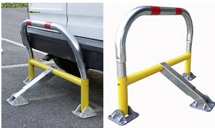
Les arceaux de parking anti-stationnement STOPCRASH sont montés sur des tubes ayant un diamètre de 60mm. Ils possèdent un système de deux amortisseurs qui limiteront les dégâts en cas de choc avec un véhicule. La fermeture se fait par verrouillage automatique. Ils sont disponibles en deux coloris : rouge ou jaune. Dimensions 970 x 405 x 650 mm
