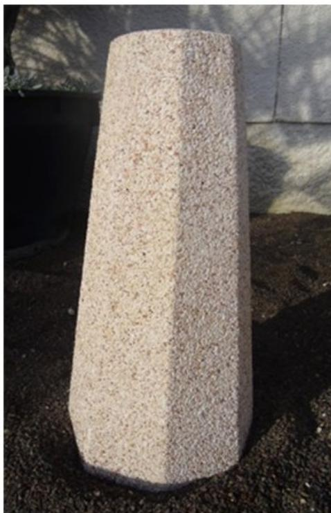
Borne hexagonale, esthétique, robuste et pratique pour limiter les accès. Fabriquée en béton désactivé. Finition type gravillon lavé : Cerdagne. A sceller. Dims (cm) : diamètre 30 X H70. Poids : 137 kg.
