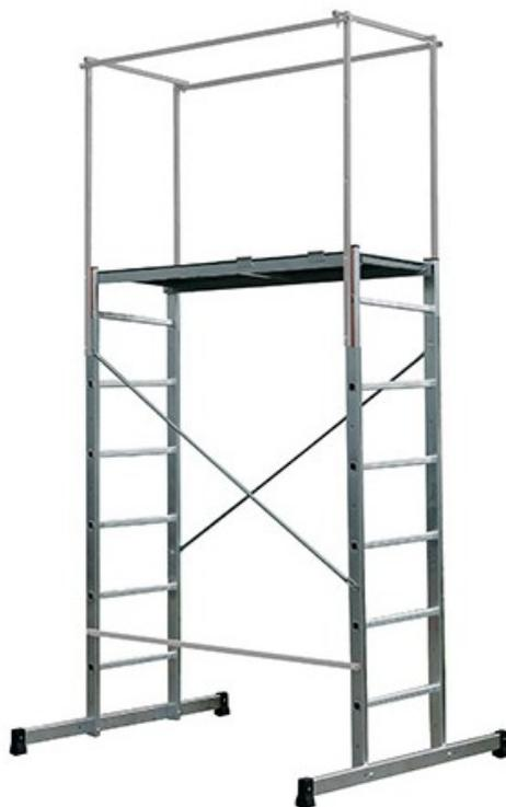
Echafaudage Aluminium ALTUS 190 Rattrapage de niveau. 2 échelles munies de leurs bases STABILISATRICE DE 1.20M Conforme à la norme E85-200 Section de montants: 60x24cm Plateau confortable 130x44 Poids: 28kg
