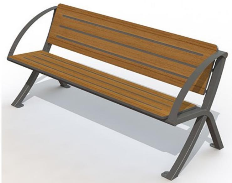
Un banc confortable et durable avec accoudoirs. Pieds en tube d'acier 50 X 40 mm, tubes horizontaux acier diamètre 42 mm, thermolaqués. Coloris RAL sur demande. Lames en compact ép. 18 mm, aspect teck, Livrés en kit à monter. Dim (cm) : L 176,2 X P 58,6 X H 78,1, Hauteur assise 43,3. Poids 46 kg.
